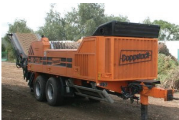
Obr. 2: Výhodou výkonného univerzálního drtiče je schopnost rozdrtit ve vstupní biomase i většinu nežádoucích příměsí
