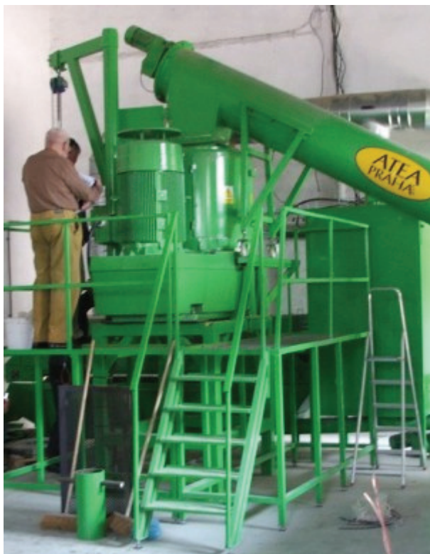
Obr. 3: Lisy na granulaci biomasy mají obvykle výkon 1 - 6 t/h
